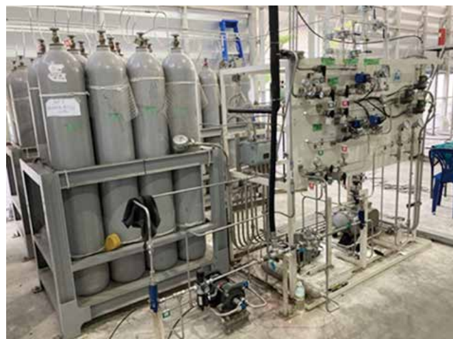
図4 高压ガスブースター(右下)及び高压バッファシリンダ(左側)
