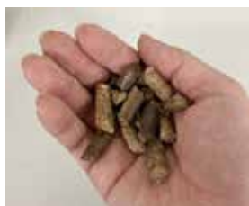
ゴムの木ペレット (第 1 回ガス化試験で使用)
