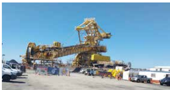
写真 3 メンテナンス中のリクレーマ
