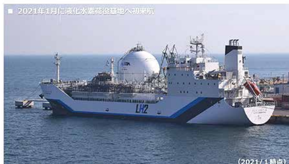
液化水素運搬船及び荷役設備
