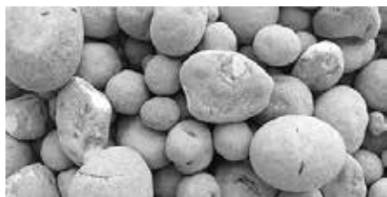
図4 合成石灰石でコーティングされた骨材製品 (出典：Blue Planet 社ホームページ)
