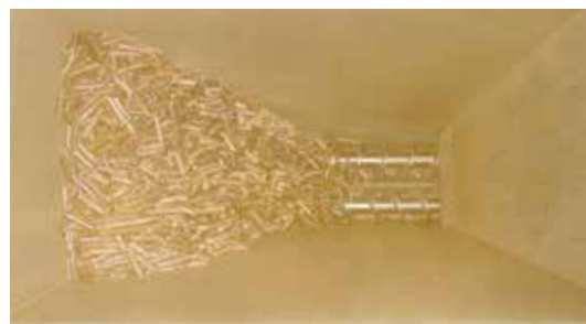
図6 供給ホッパ内部のバイオマス
