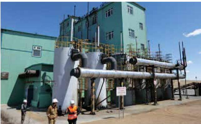
(MAK社、中国製縦型流動式乾留炉、閉鎖中)
