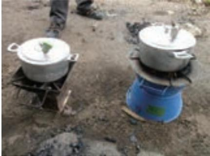
鉄製コンロとムパワーラコンロの燃焼比較試験
