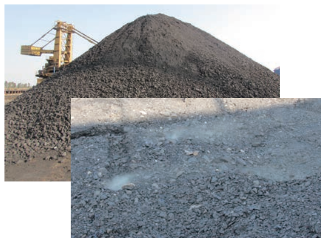
自然発熱のため貯炭場の石炭から蒸気が出ている様子
