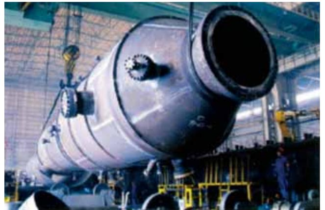
図8 ガス化炉
