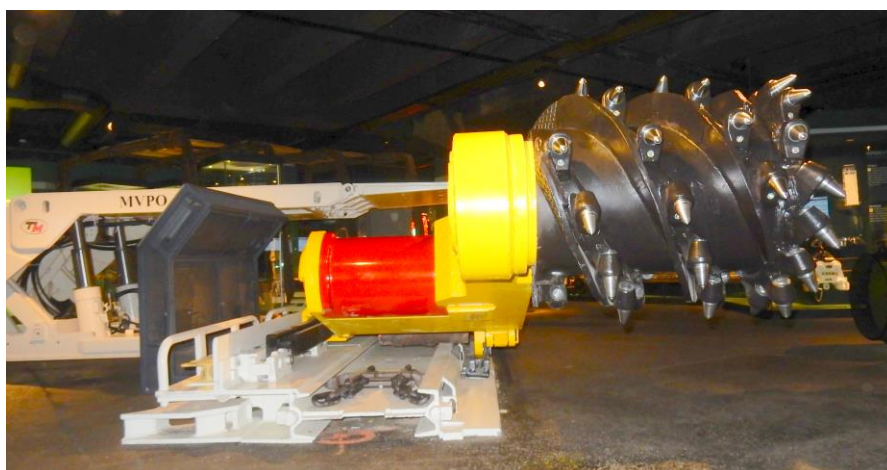
写真 2 ロングウォール切羽での薄層用自走枠とドラムシヤラー
