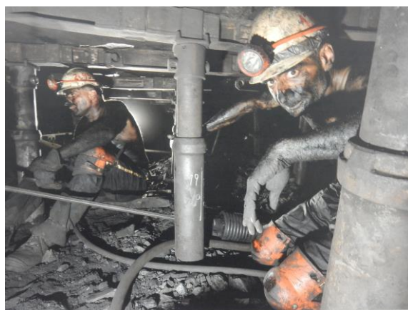
写真 1 まだ自走枠が無い時代の薄層採炭現場
