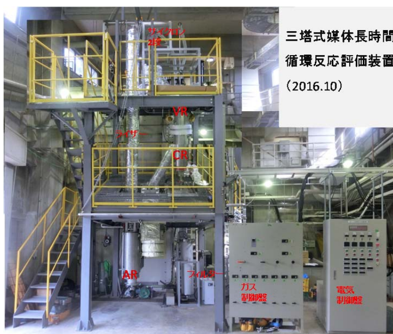
図1 三塔循環流動層媒体循環反応評価装置
