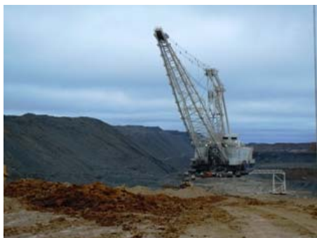
図-2 110m の高さも持つドラグライン
