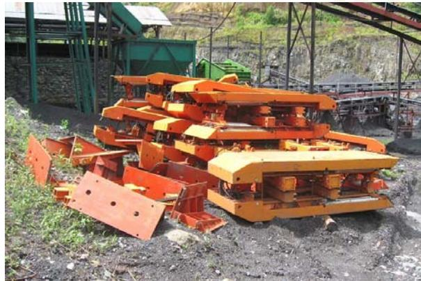
写真. SRU炭鉱の鋼棒天板(改良型)
