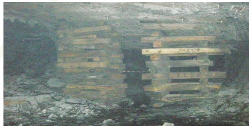
坑道交差部の採掘跡側で廃棄される坑道
