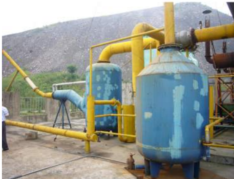
写真 低濃度ガス安全輸送試験装置及びガスエンジン
