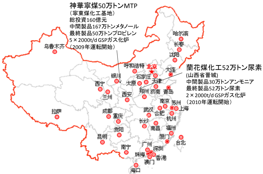
図1 GSP ガス化技術を導入した中国企業及び建設中の GSP ガス化炉規模
