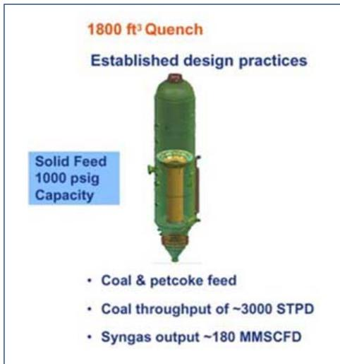
図 2 2008 年に公表された GE 大型ガス化炉イメージ
