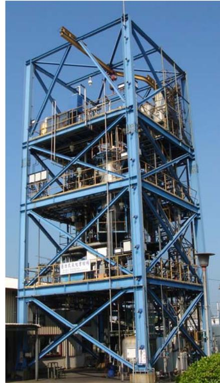
写真1 2t/d 石炭ガス化試験装置
