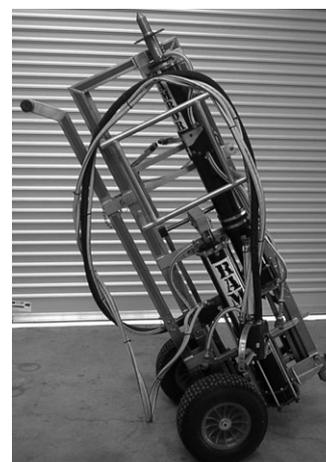
写真1 Ram bor社製ボルト打設機Trussmaster 1
