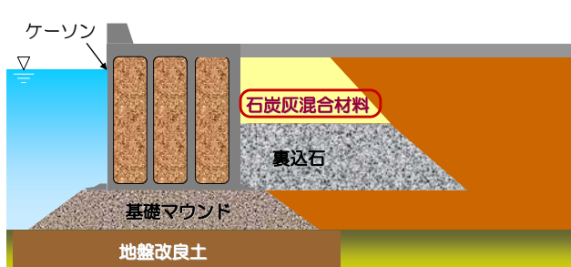
(1) 重力式岸壁（護岸）の裏込め・埋立材料への適用
