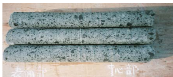
写真-2.11 完成した消波ブロックとコアの状況 8)
