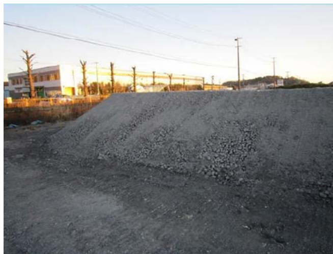
写真-3.2 破碎材（J-アッシュ）の養生状況
