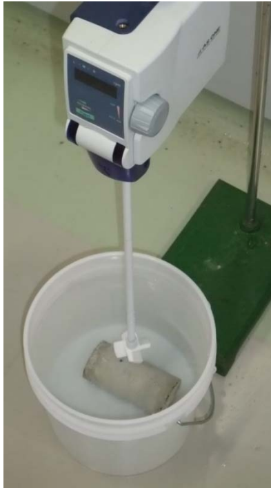
図-5.3 JIS K 0058-1 の 5. 利用有姿による試験の実施状況
