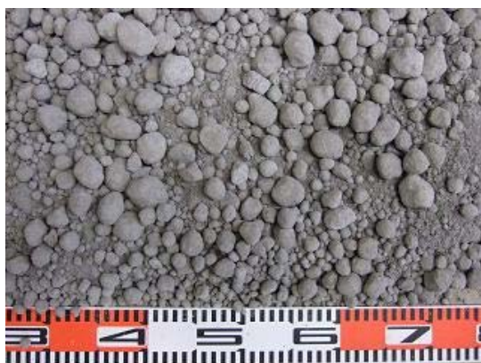
写真-2.4 造粒材（灰テックビーズ）と製造プラント
