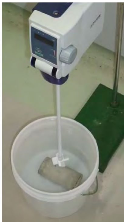
図-4.3 JIS K 0058-1 の 5. 利用有姿による試験の実施状況
