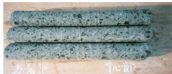
写真-3.6 完成した消波ブロックとコアの状況 5)
