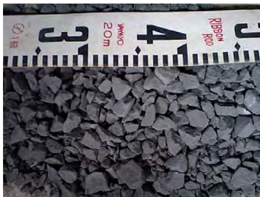
写真-3.1 固化体破碎材（頑丈土）
