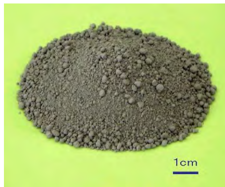
写真-3.3 固化体造粒材（ゼットサンド）
