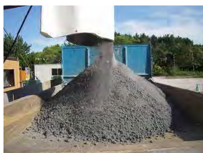
写真-2.19 石炭灰混合材料の固化体（頑丈土）の製造、破砕材の製造
