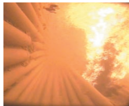
バーナーから噴射された微粉炭の着火
