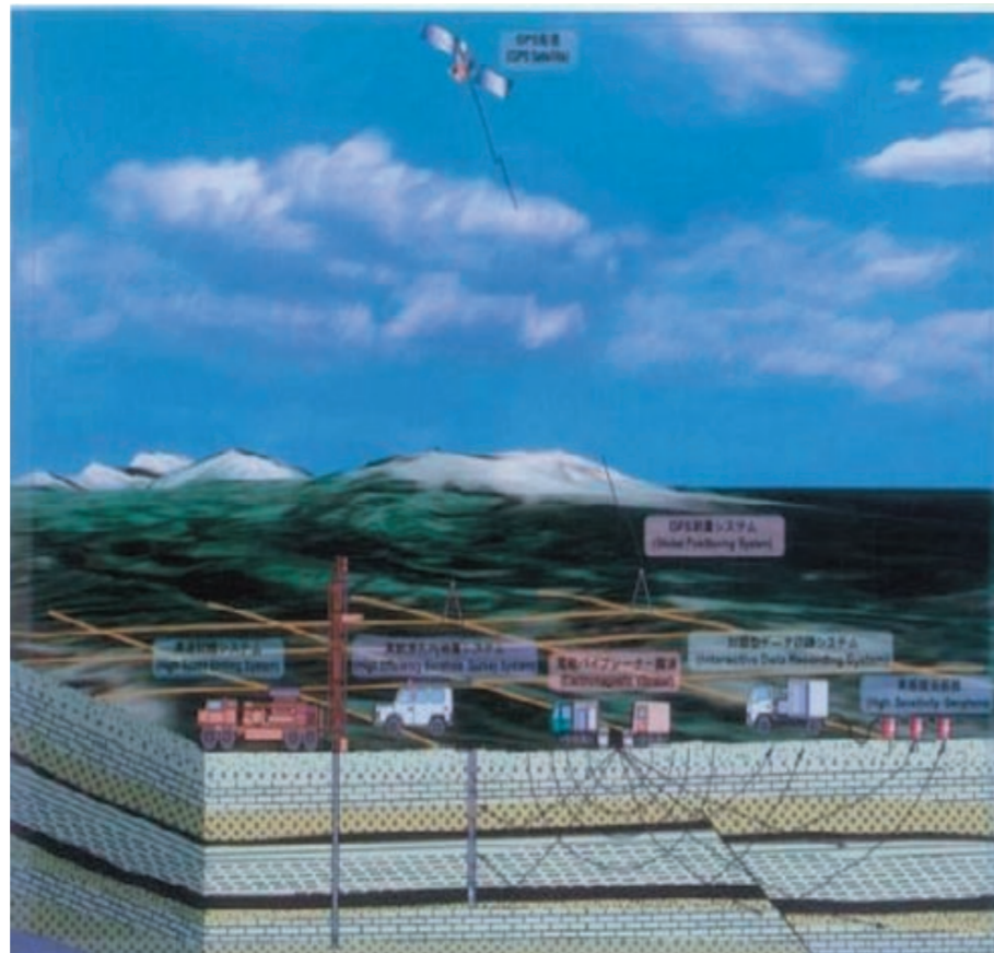
石炭探査の模式図：試錐と反射法地震探査の組み合わせにより効率的な探査ができます。石炭賦存状況の評価は、各種の調査成果を総合的に解釈して行います。これらの結果をデータベース化し、地質や炭層モデルを作成します。
